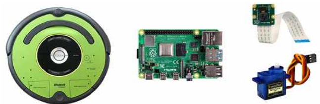
[그림 1] 이미지 데이터 수집 시스템의 주요 구성
